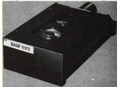
Afb. 2. BASF Winchester disk drive met een opslagcapaciteit van 21.2 Mbyte.
