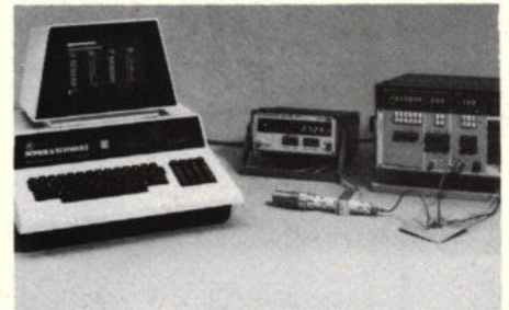
Afb. 2. Het opzetten van automatische meetprocedures is een van de mogelijkheden van microprocessorgestuurde instrumenten. (foto: Rohde & Schwarz)
